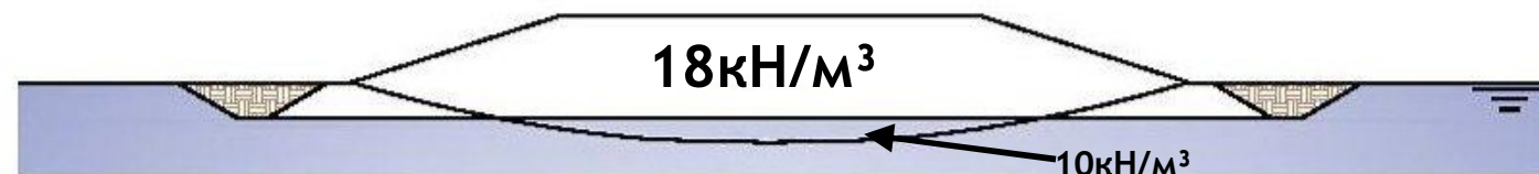
Влияние дрена на плавучую конструкцию
